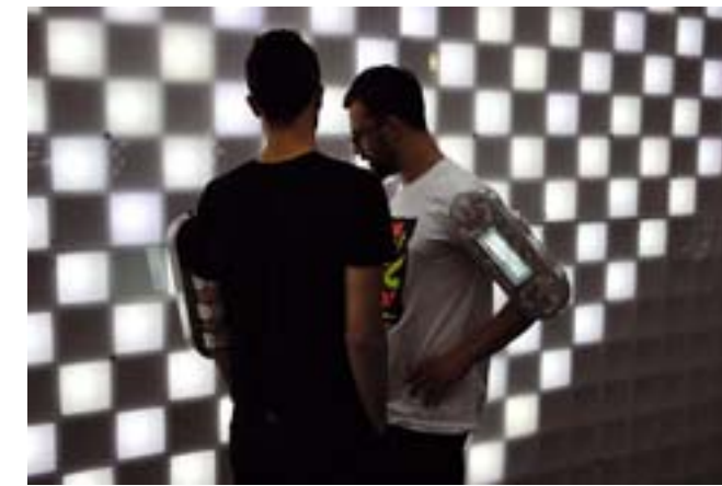
Mit Hilfe auf Folienkissen befestigter LED Leuchtmittel können beliebig große Darstellungsflächen entstehen.
